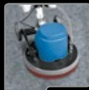
Manutenzione a secco: deceratura e lucidatura di pavimenti vinilici
